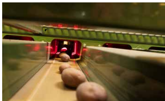
Met optische sortering kan de sorteercapaciteit omhoog worden gebracht
